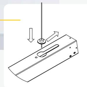
Ranura para desplazamiento en caso de obstrucciones en la losa o plafón.
